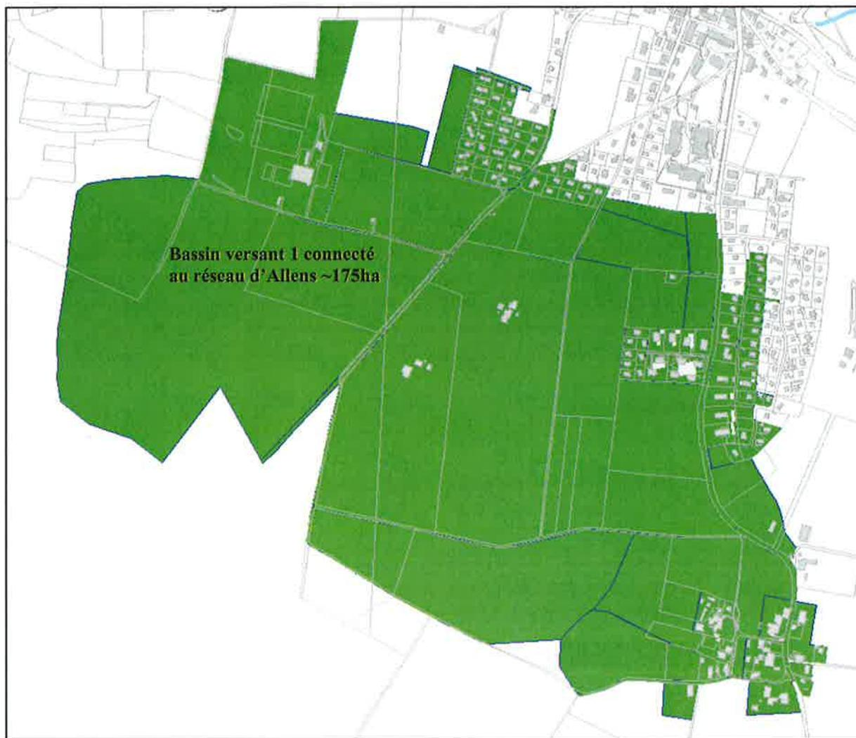
La surface du bassin versant est recouverte en majorité par des zones agricoles de surface perméable et des zones d'habitation de faible à moyenne densité. Le développement important cité en introduction de ce préavis sur ce bassin versant représente 42 ha de zone à bâtir.
