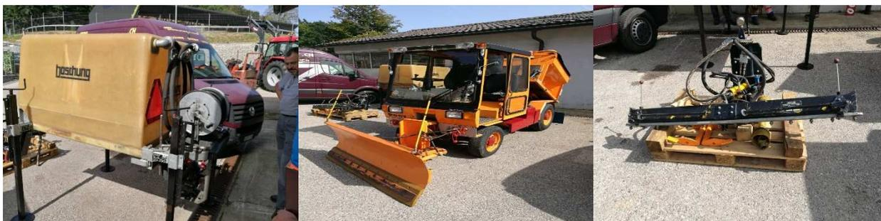
En effet, au lieu du mono-axe qui exigeait un passage pour le déneigement, puis un deuxième passage pour le salage, le tout se fait maintenant en une fois et plus rapidement. Avec cet engin, nous sommes aussi équipés pour le nettoyage des fontaines et chemins par aspersion.
