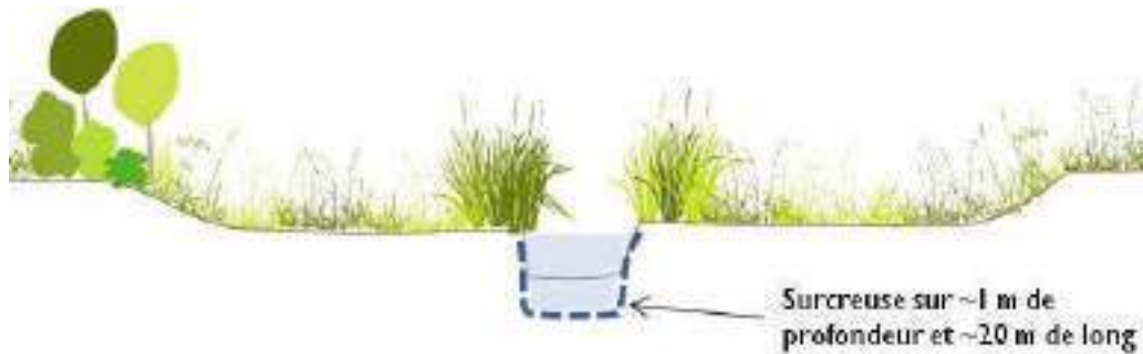
Figure 30 : Surcreuse locale dans le lit d'un cours d'eau.
