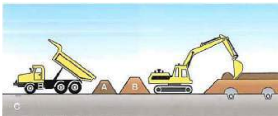
Figure 16 Exemple de remise en état à la pelle mécanique depuis l'horizon C (source : ASG 2011).
