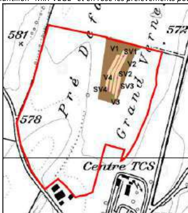
Figure 5 : Situation des prélèvements d'échantillons pour les analyses selon OSOL (en rouge le périmètre de comblement du futur projet d'extension, en brun le périmètre inscrit au cadastre des sites pollués, en saumon l'emplacement des stocks de sols en place, en vert les prélèvements pour l'échantillon "MIX-VEGE" et en rose les prélèvements pour l'échantillon "MIX-SV")
