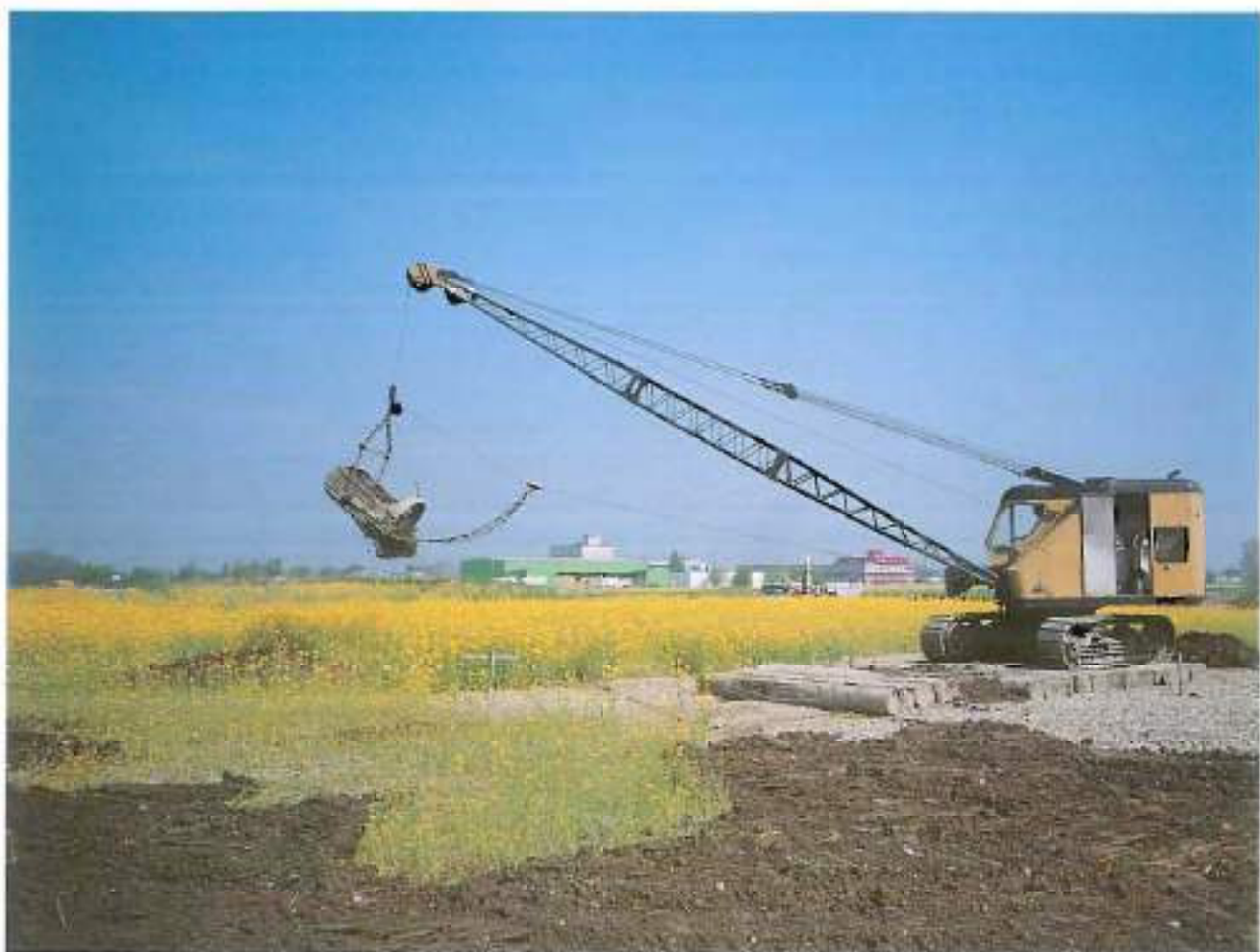
La remise en état d'un sol est une opération complexe et coûteuse. Il faut utiliser des machines adaptées telles qu'une pelle hydraulique, un broyeur version LQP ou une pelle à câbles (photo), et procéder à un ensemencement intermédiaire. La remise en culture doit donc ménager le sol.
