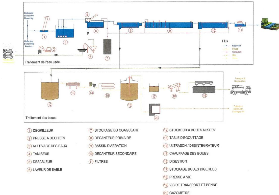
Les eaux usées arrivant à la STEP sont dégrillées pour enlever les parties solides, papier etc, dessablées et dégraissées. Les déchets de dégrillage sont incinérés et le sable est lavé et mis en décharge.
