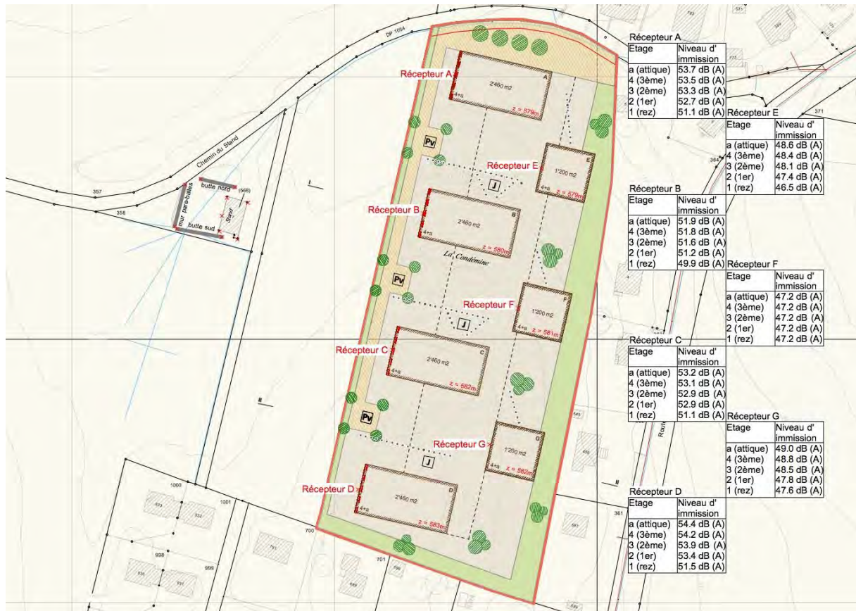
Figure 5.5 Résultats de la modélisation du bruit lié au stand de tir perçu en façade de chaque étage des bâtiments prévus
