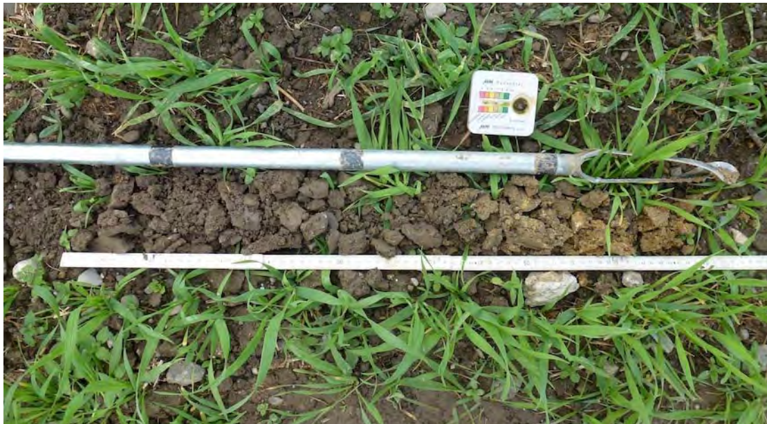
Figure 5.14 Sondage n°1 montrant un sol carbonaté limono-sableux, de 50cm de profondeur environ
