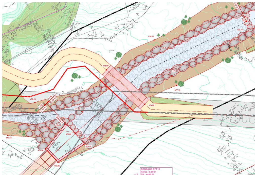
Figure 20 : Aménagement du ruisseau à la sortie de la galerie
