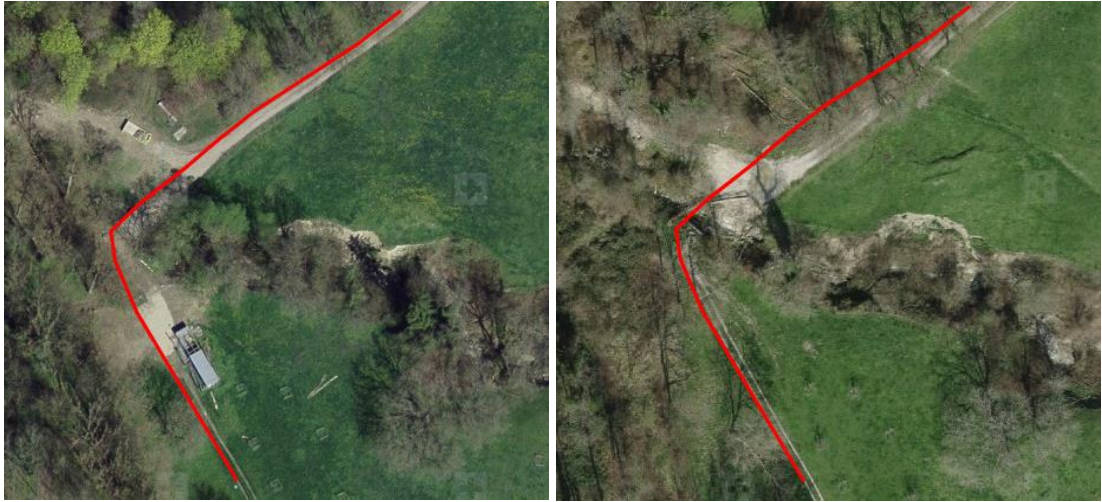
Figure 3: Glissement en rive gauche entre 2013 (gauche) et 2020 (droite) de 6 m. La rive droite, quant à elle, semble beaucoup moins bouger.
